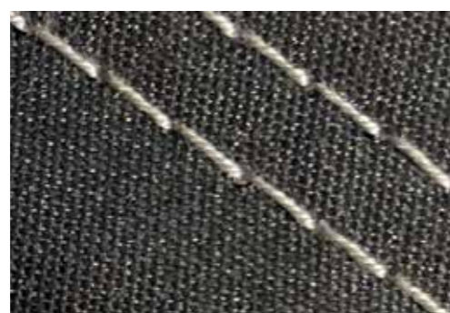
Alle naden zijn voorzien van dubbele stiksels.
