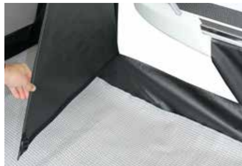
Ritsen bij de aansluitsplit zodat u bij het serviceluik kan.
