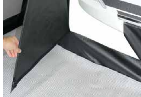
Ritsen bij de aansluiting zodat u bij het serviceluik kan.
