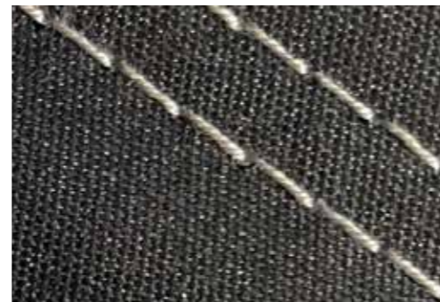
Alle essentiële naden zijn voorzien van dubbele stiksels.
